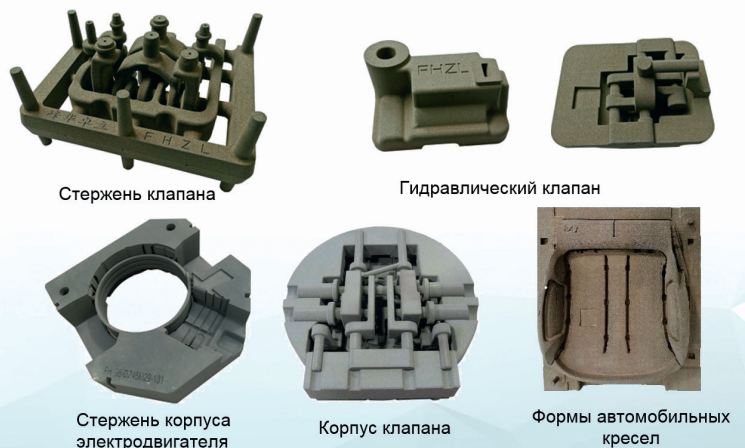
Рис. 8. Внедрение печати песчаных форм. Фото FHZL из презентации i3D
