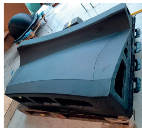
Рис. 4. Напечатанная оснастка со сложной отфрезерованной поверхностью
