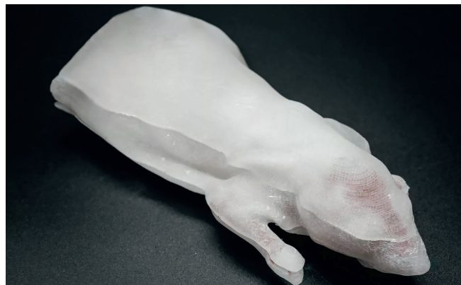
Рис. 15. Дозиметрический фантом, напечатанный на 3D-принтере
