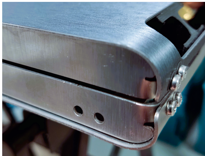
Рис. 5. Гибочная оснастка из PLA-пластика в сборе с метрическим крепежом (слева) и места гибов готовой детали, установленной в изделии (справа)
