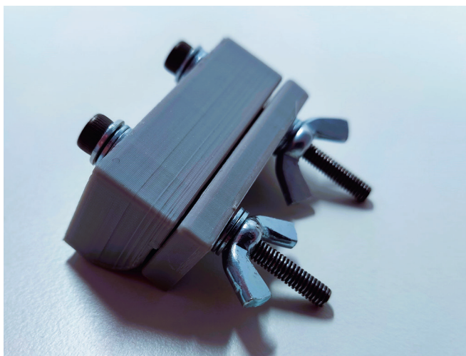
Рис. 5. Гибочная оснастка из PLA-пластика в сборе с метрическим крепежом (слева) и места гибов готовой детали, установленной в изделии (справа)
