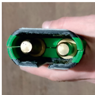
Рис. 5. Вилка для проводов внешнего запуска двигателя «КАМАЗ» (Clotho ABS GF13)
