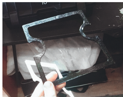
Рис. 7. Изготовление прокладки клапанной крышки «КАМАЗ» 740.1003270-11 (TPU A70)
