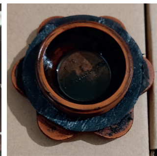
Рис. 8. Прокладка крышки маслозаливной горловины АМ «КАМАЗ» (TPU A70)
