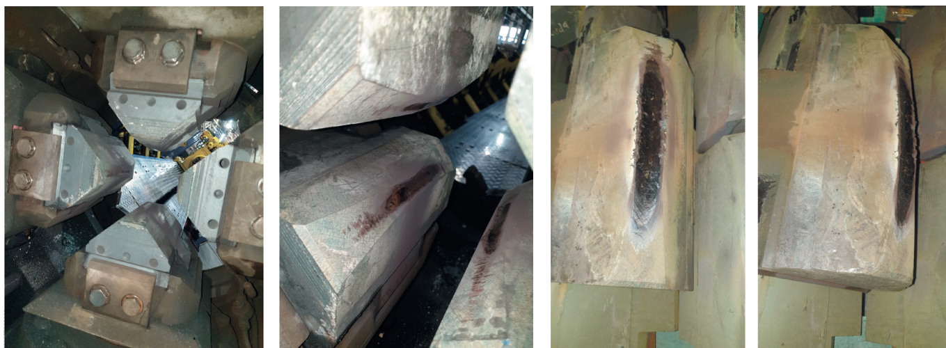
Рис. 4. Внешний вид комплекта бойков, установленных в машину, и боек после выхода из строя
