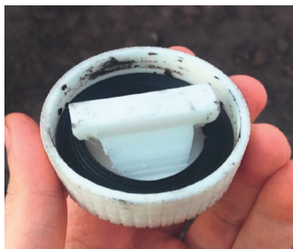
Рис. 11. Крышка маслозаливной горловины «КАМАЗ» (ABS PA), прокладка (TPU D70)
