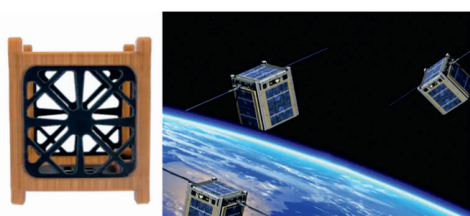
Рис. 2. Корпус космического аппарата формата CubeSat, изготовленный из PEEK на 3D-принтере Intamsys Funmat 410
