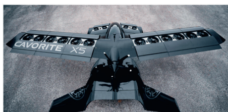
Рис. 3. Прототип беспилотного самолета Cavorite X5 с вертикальным взлетом и посадкой компании Horizon Aircraft оснащен 780 3D-печатными деталями из угленасыщенного композита PEEK-CF, изготовленными на 3D-принтере Intamsys Funmat Pro 410
