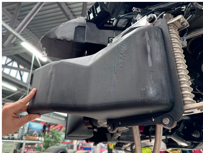
Рис. 2. Пример: воздуховод на Nissan GTR? напечатанный угленаполненным ABS-пластиком
