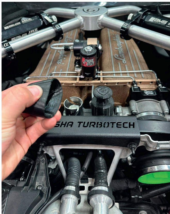
Рис. 1. Пример: заглушки для автомобиля Audi R8 из ТПУ-пластика
