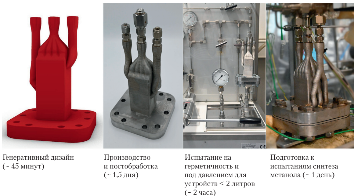
Рис. 6. Ускорение разработки химических реакторов за счет автоматизированного проектирования: быстрое создание и оптимизация геометрии за 45 минут, успешный синтез метанола при давлении H_2/CO_2 50 бар на установке KIT-IMVT (проведены испытания под давлением до 105 бар). Изображения: KIT-IKFT
