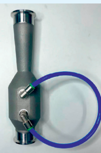
AM.TECH. Трубка Вентури — элемент системы контроля расходных скоростных характеристик газового потока. Технология: SLM. Материал: 12X18H10T. Время: 27 часов. Высота: 215 мм.
