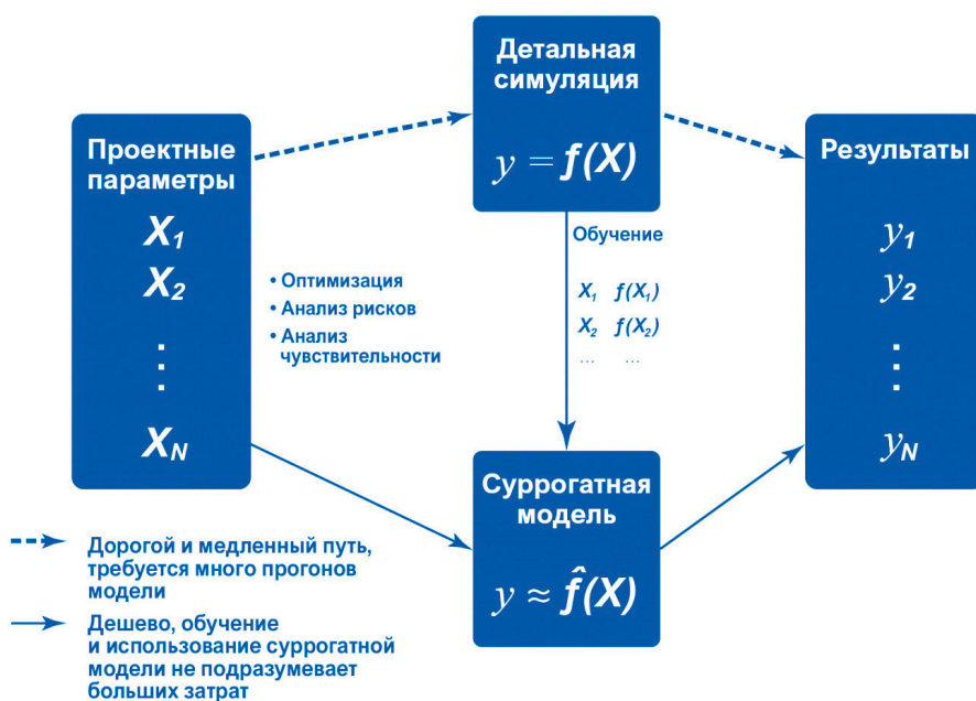
Рис. 9. Схема суррогатного моделирования [8]
