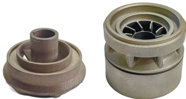
Рис. 2. Рабочее колесо и направляющий аппарат для ступеней ЭЦН, выполненные по MBJ-технологии
