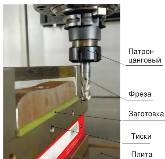
Рис. 4. Схема фрезерования периферией фрезы
