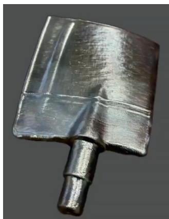
Рис. 3. Лопатка шахтного вентилятора, выращенная в трех координатах лазерно-дуговой наплавкой (материал: ВТ6 проволока диаметром 1,2 мм, высота слоя: 0,8 мм, габариты: 150×200×35 мм, пропуски: 0 мм, масса наплавки 0,6 кг). Обрабатываются только посадочные поверхности. Затраты на материалы: проволока — 6 т.р., газ аргон — 5 т.р., электричество — 7 т.р., итого 18 т.р. Время выращивания: 2 часа. Фото: компании xWeld
