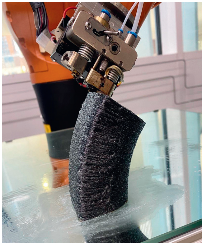
Рис. 7. Многоосевая композитная 3D-печать с применением промышленного робота
