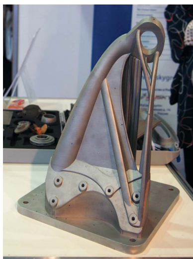
Рис. 9. Вариант конструкции поддержек соединительного блока
