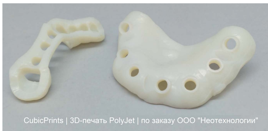
Рис. 1. Напечатанная из фотополимера модель челюсти
