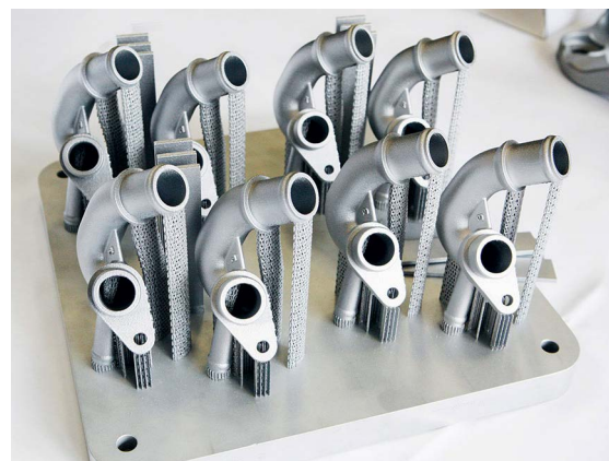
Водяные коллекторы для двигателя W12, отпечатанные на SLM280
