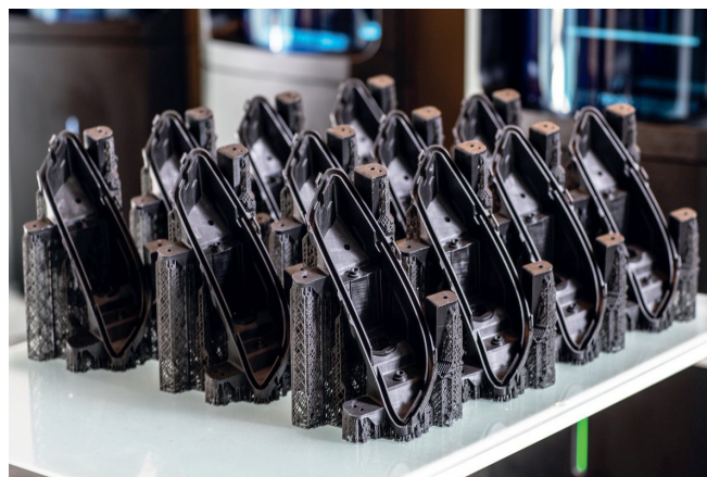
Изделия из нового прочного фотополимера xPRO410 для высокоточной печати, созданного Nexa3D совместно с Henkel. Фото: Henkel
