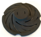
Печать графитового сердечника ротора Материал 3D-печати: графит
