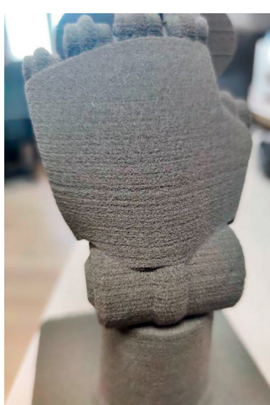
Рис. 12. Плохое состояние печатающей головки — «полосит»
