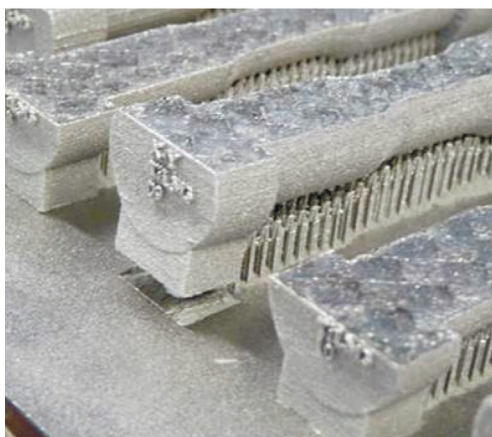
Рис. 1. Неудачная попытка изготовления простых цилиндрических образцов для испытания на растяжение
