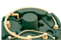
Печать песчаных литейных стержней Материал 3D-печати: литейный песок, фенольная смола
