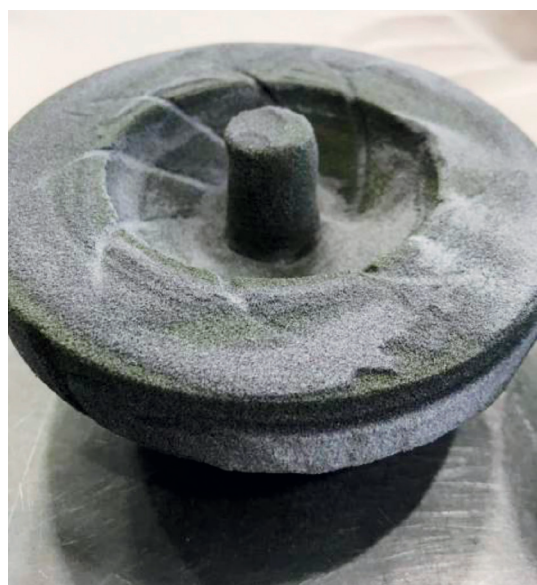
Рис. 11. Сдвиг-смещение геометрии части формы
