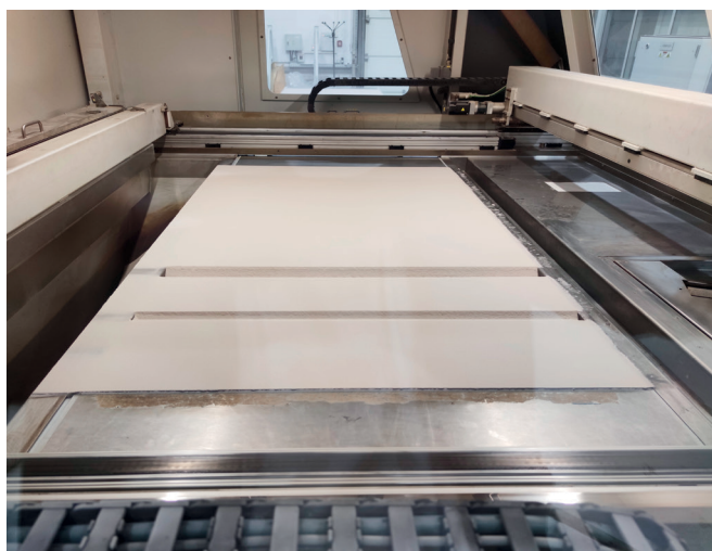
Рис. 8. Засорение рекоатера влажным песком
