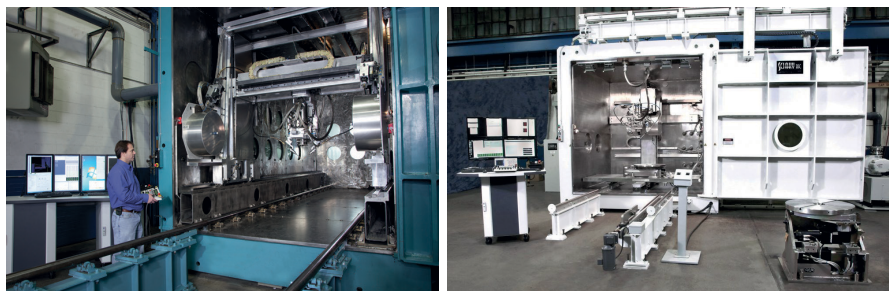
Рис. 10. Установки для ЭЛПП крупногабаритных изделий компании Sciaxy ЕВАМ 300 ЕВАМ 110
