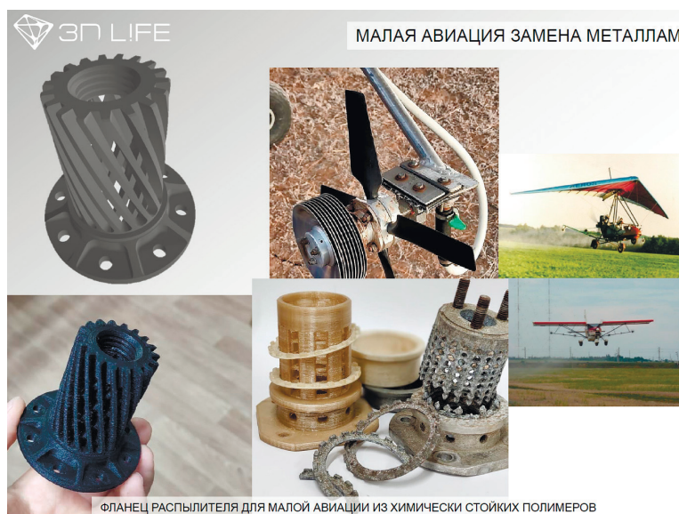
ФЛАНЕЦ РАСПЫЛИТЕЛЯ ДЛЯ МАЛОЙ АВИАЦИИ ИЗ ХИМИЧЕСКИ СТОЙКИХ ПОЛИМЕРОВ
