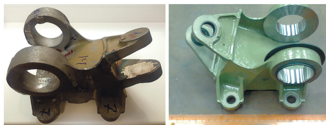
Рис. 4. Изделия, выполненные на оборудовании компании Farsoon (КНР): а — рулевая часть летательного аппарата, б — рулевая часть летательного аппарата; в — форсунка. Фото из презентации SIU System
