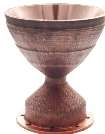
Рис. 6. Гильза медного ракетного сопла весом 17,9 кг, напечатанная за 199 минут по технологии ХГН (SPEE3D, Австралия)
