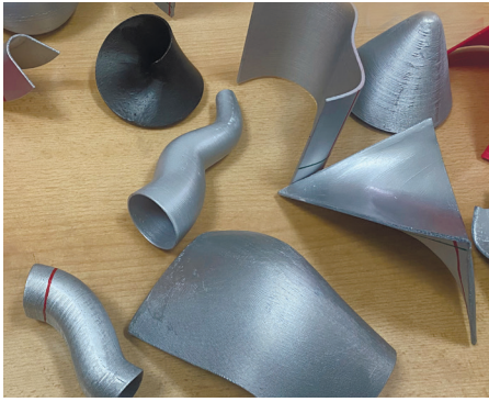
Рис. 6. Упрощение сложных поверхностей (ступенчатые вместо конических)
