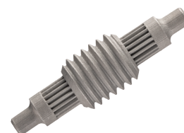
Фото 2. Роликовый винт, уменьшенный с семи частей до одной после объединения конструкции для аддитивного производства
