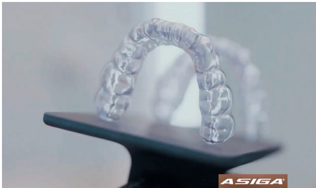
Рис. 2. Шина, напечатанная по технологии UltraGLOSS. Фото: компания Asiga
