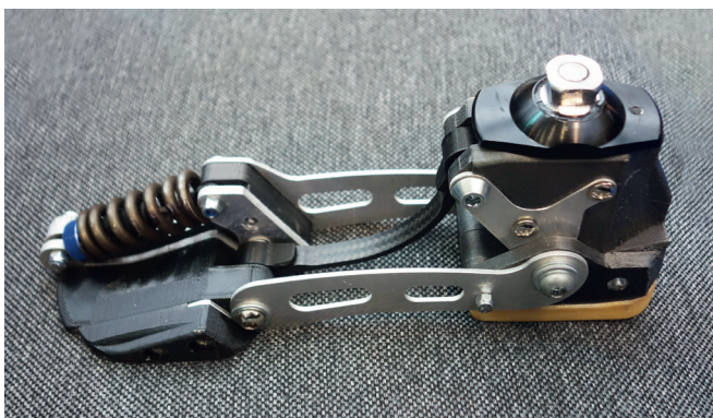
Рис. 1. Протез ступни с карбоновыми деталями ООО «Медиатроника»
