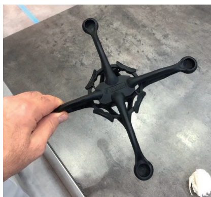
Рис. 1. Рама дрона, материал PEEK-CF
