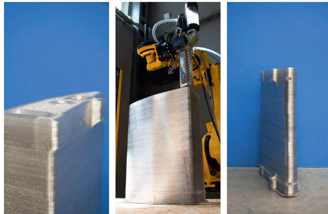
Рис. 1. Обтяжной пуансон для вытяжки панели крыла ТУ-214, вес — 40 кг, материал — 3С, время печати — 18 часов, габариты — 700×500×250 мм, напечатано на F2 Pellet
