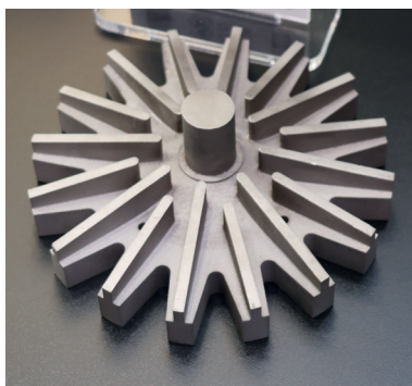
Рис. 3. Изделия ЦАТ Ростех: а) рабочее колесо открытого типа, б) кронштейн радиоэлектронной аппаратуры
