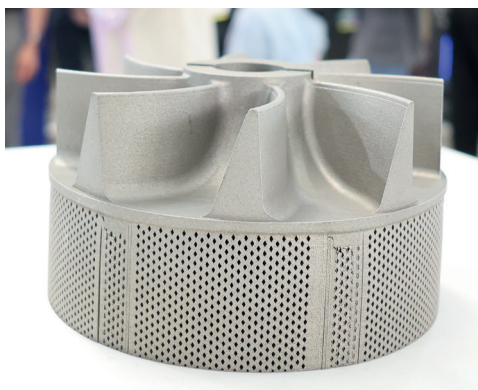
Рис. 1. Импеллер – выполнен «РосАТ» по SLM-технологии.
