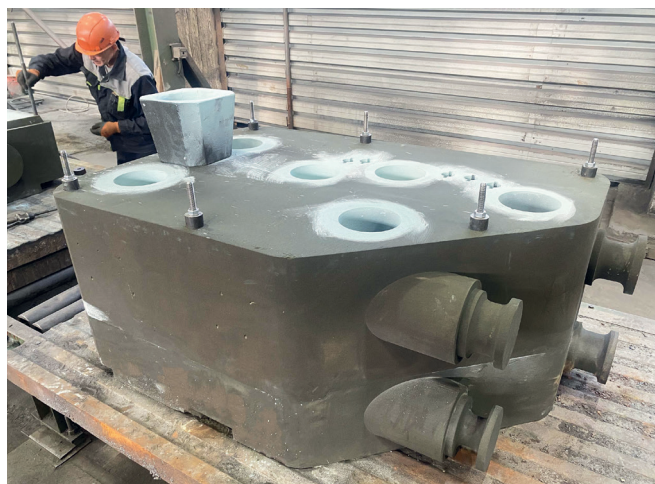
Песчано-полимерные формы напечатаны на оборудовании Kosel
