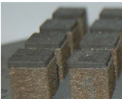
Рис. 1. Варианты формирования полиметаллических изделий с помощью технологии селективного спекания слоев
