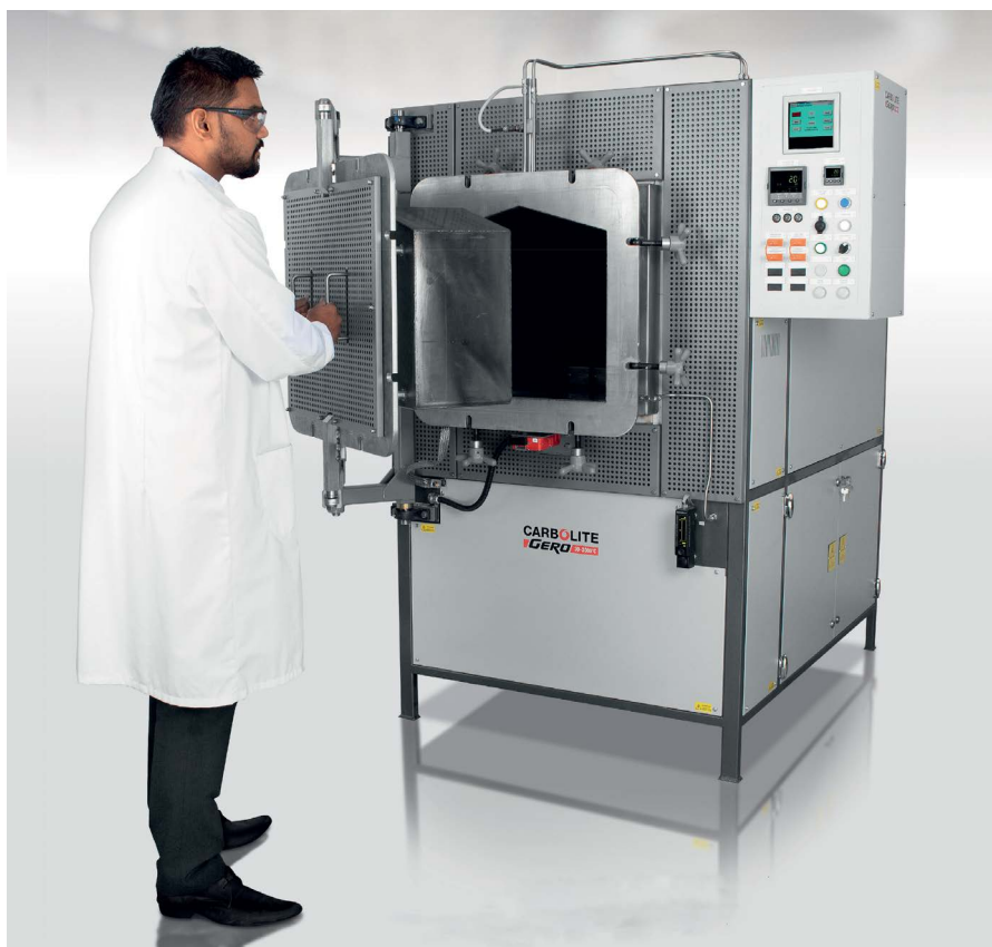
Рис. 1. Печи GPCMA для термообработки в регулируемой газовой среде с максимальной рабочей температурой до 1200 °C и содержанием кислорода <30 ppm, предназначенные для снятия внутренних напряжений изделий, изготовленных методом селективной лазерной плавки
