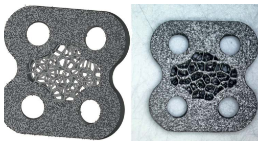
Рис. 17. Имплантат в виде пластины для шейного отдела позвоночника с пористой структурой (а – дизайн, б – пластина после финишной обработки)
