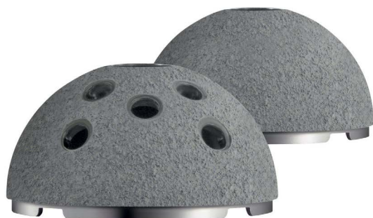
Рис. 12. Имплантат тазобедренного сустава (с улучшенными характеристиками) включает полусферическую ацетабулярную чашку с плазменным покрытием титаном размерами 42–74 мм, с 3–5 отверстиями, полиэтиленовый вкладыш с шаровым шарниром, ножку с пористым покрытием. Возможно нанесение покрытия PureFix HA (hydroxyapatite) для быстрой остеоинтеграции
