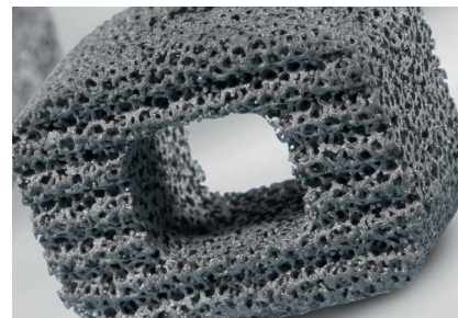
Рис. 14. Пористый танталовый имплантат ТМ-S из материала Trabecular Metal аналогичен губчатой структуре кости
