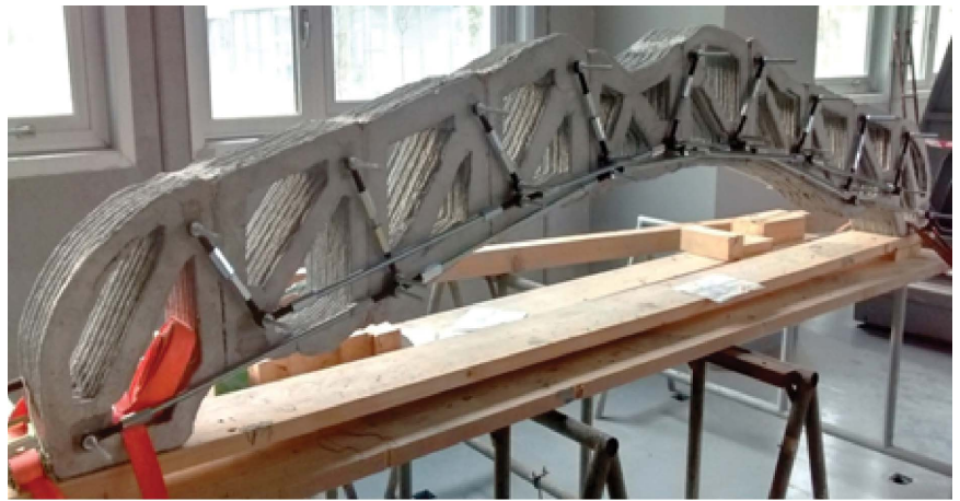
Рис. 18. Арка моста в сборе с металлическими усилениями
