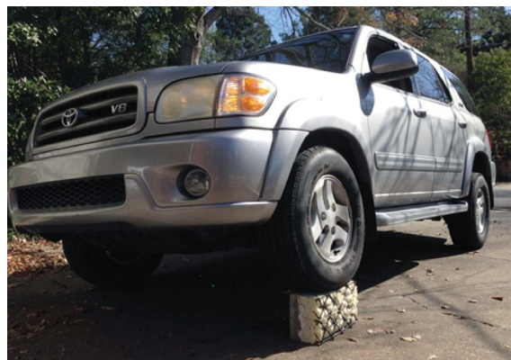
Рис. 12. Сетчатая структура с пеной выдерживает значительную нагрузку
