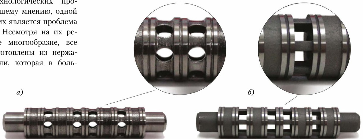
Рис. 3. Золотник гидрораспределителя выполнен: а) по традиционной технологии, б) с помощью АТ
