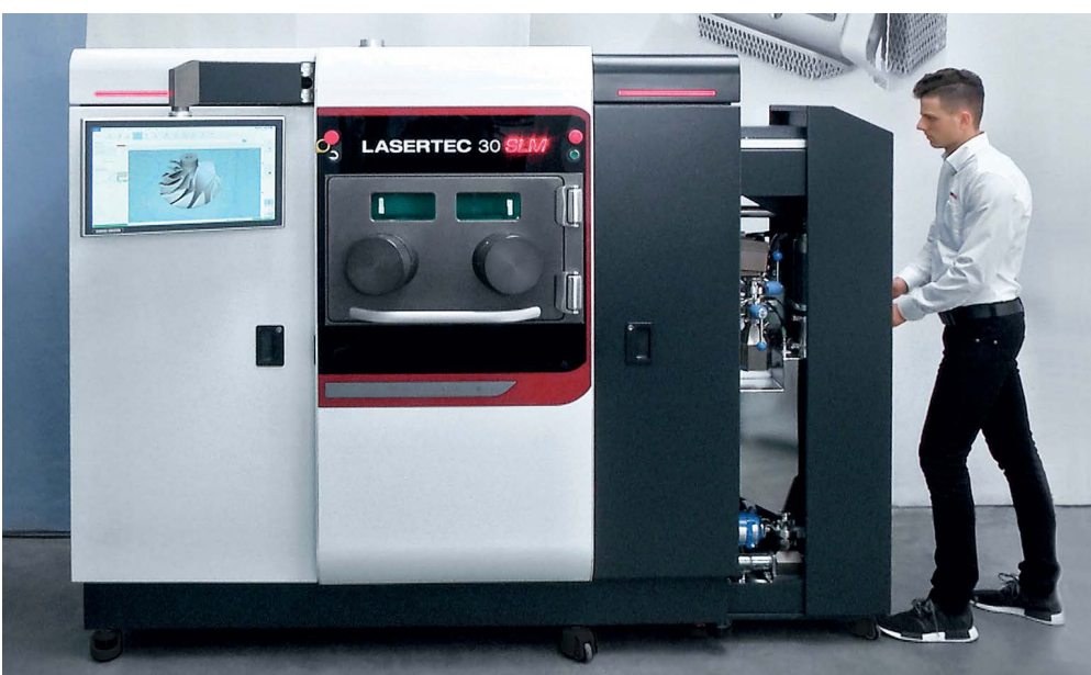
Сменный модуль подачи порошка позволяет менять порошок менее чем за два часа
