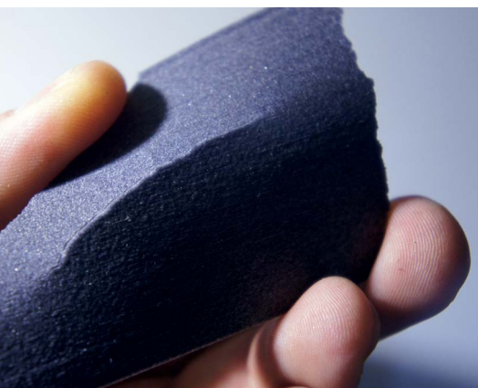
Рис. 7. Пластина 1 мм толщины, напечатанная вертикально. Трещина при механическом разрушении идет в произвольном направлении, что свидетельствует об однородности механических свойств вдоль и поперек слоев распечатки
