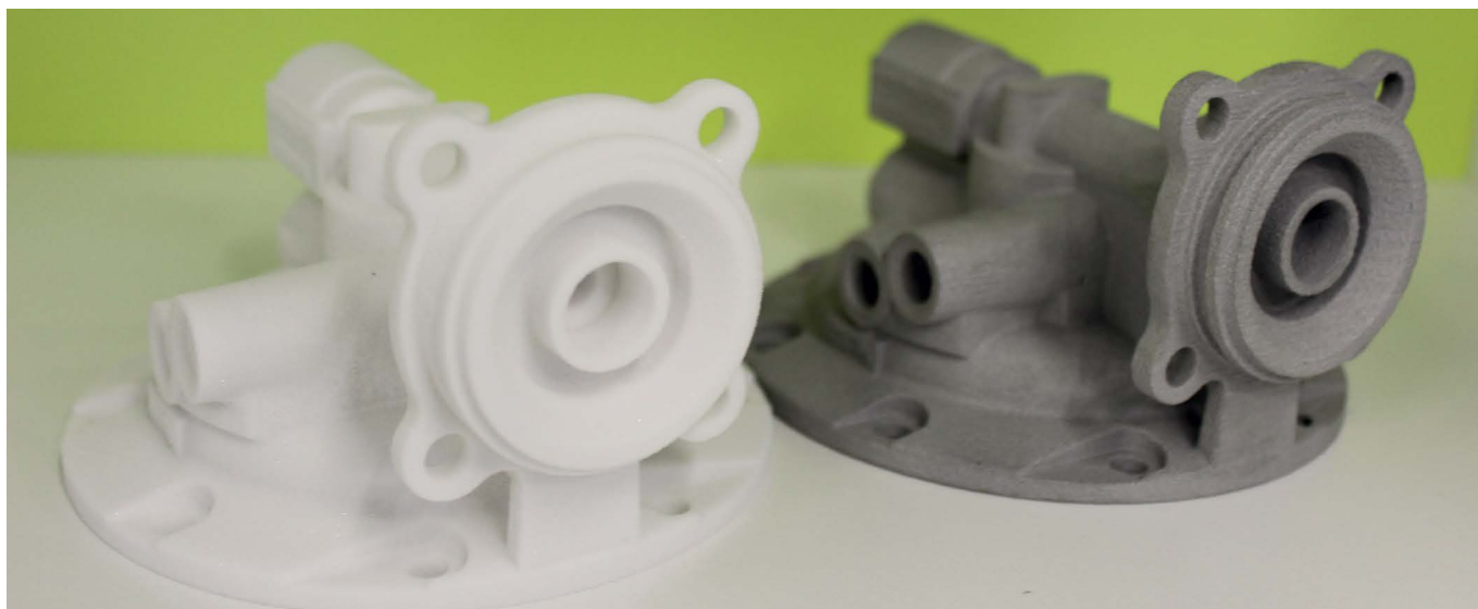
Рис. 1. Напечатанная выжигаемая модель детали «корпус» и отливка из алюминия (3D-принтер Voxeljet VX500, Германия). Материал отливки АК7ч, материал модели: полиметилметакрилат. Фото предоставлено ГК «Остек».
